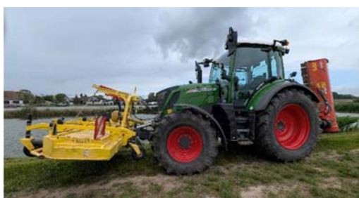
Bild 2: Fendt 313 Fario mit Böschungsmulcher und Frontsichelmulcher
