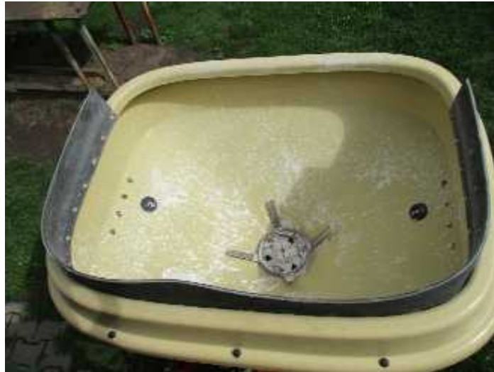
Durch Streukrone restlos geleerter Trichter
