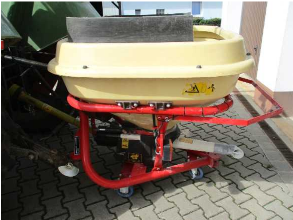
Durch Streukrone restlos geleerter Trichter
